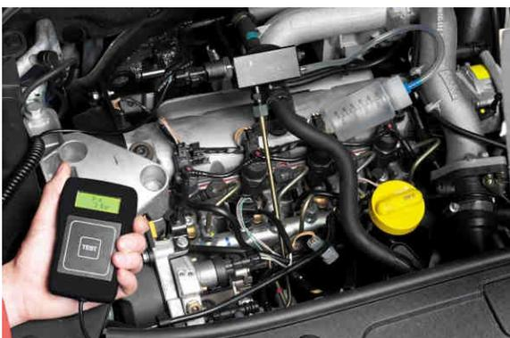
con la presión especificada para esta aplicación, hay un fallo en la bomba y debe remplazarse.
